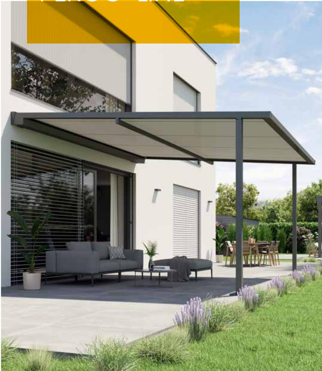
Die Pergola Markise ist vor allem für den Einsatz als freistehende Beschattung und als Wetterschutz von Terrassen und Raucherzonen geeignet. Die Befestigung erfolgt mittels zwei einstellbaren Wandkonsolen und zwei Stehern mit schraubbarer Grundplatte zur Befestigung am Boden. Das Gegenzugsystem der XLINE garantiert eine gleichbleibende Tuchspannung.
